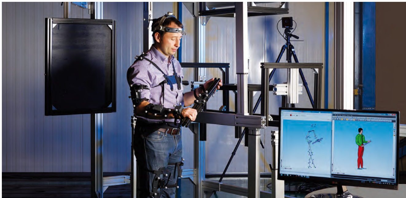
Einsatz digitaler Menschmodelle zur ergonomischen Gestaltung von Maschinen- und Arbeitsplätzen in der Entwicklungsphase sowie Analyse bestehender Arbeitsprozesse.
